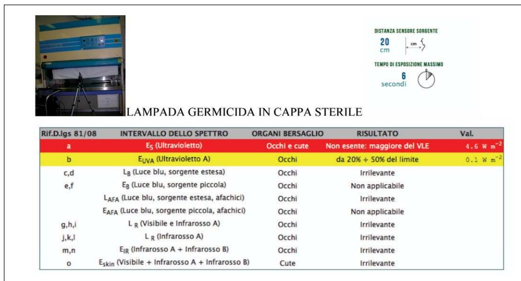
**Figura 1. Esempio di presentazione delle misure contenute in banca dati ROA del Portale Agenti Fisici: Misure su Lampada Germicida installata in cappa sterile da laboratorio**
