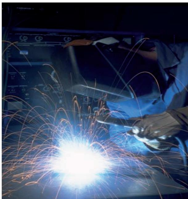
Figura 1. Saldatura manuale con elettrodi rivestiti
