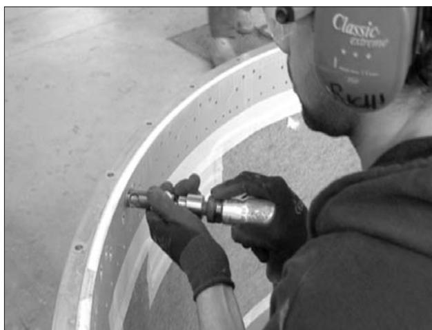
Figura 3. Esempio di fase preparatoria del foro: svasatura
